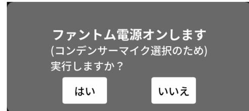
「はい」をタップすると、「コンデンサー」に設定されたマイク入力にファントム電源 (+48V) が供給されます。
